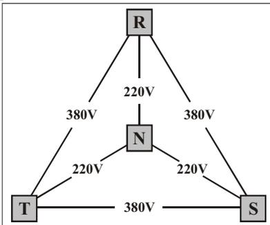
Na figura 5 podemos ter tensão de 380V entre fases, constituindo assim uma configuração em triângulo ou podemos ter 220V entre fase e neutro, o que nos fornece a configuração em estrela.
