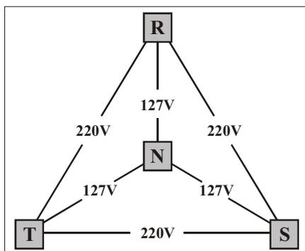
Observe na figura 2 que podemos ter 220V entre fases, constituindo assim uma configuração em triângulo ou podemos ter 127V entre fase e neutro, o que nos fornece a configuração em estrela. A rede elétrica possui configuração em 220V ou 380V dependendo da localidade, concessionária, etc...
