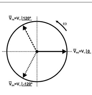
Na figura 3 podemos observar que as fases possuem uma defasagem de  $120^\circ$  entre elas. Por este motivo quando trabalhamos com a diferença de potencial entre fase e neutro temos 127V (na configuração de rede 220V) e quando trabalhamos com diferença de potencial entre fases temos 220V e não 254V como num primeiro momento seria esperado. Para um sistema trifásico simétrico a relação entre tensão de linha e tensão de fase é dada conforme a figura 4.
